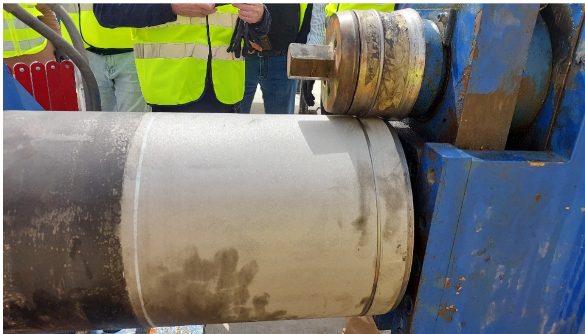
Рисунок 9 – Формирование штифтового конца трубы
