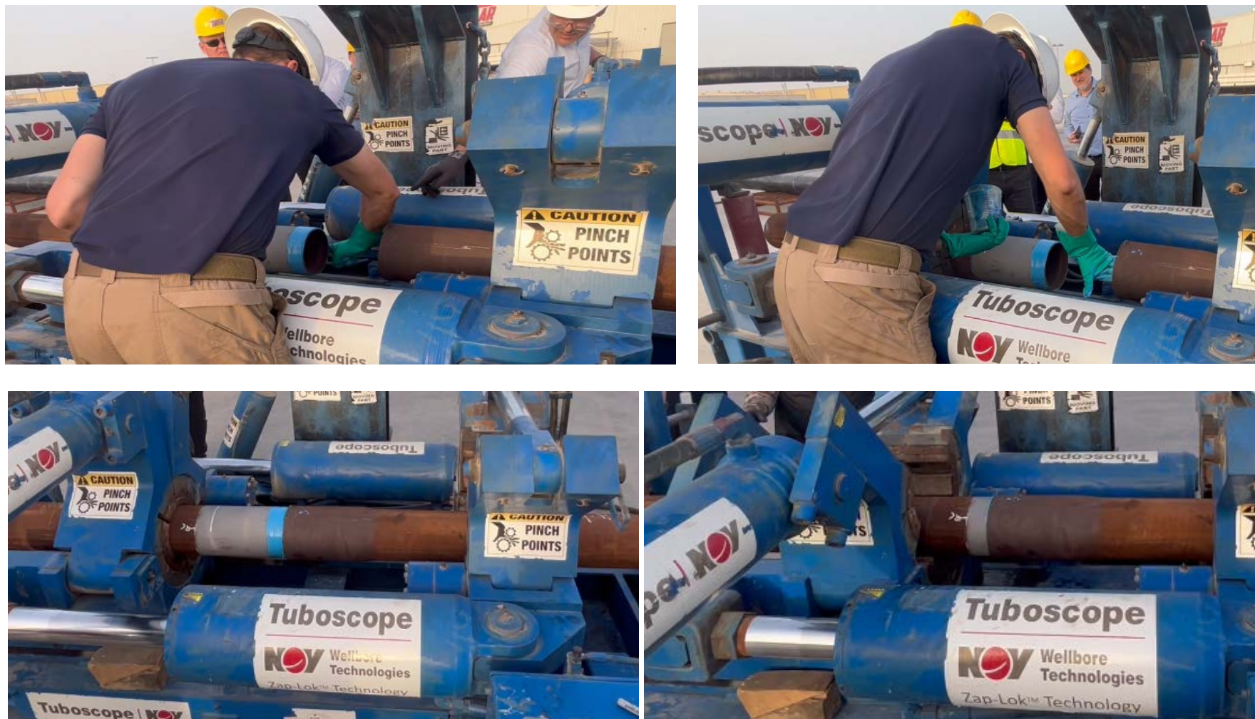
Рисунок 10 – Нанесение жидкой эпоксидной смазки и соединение концов труб
