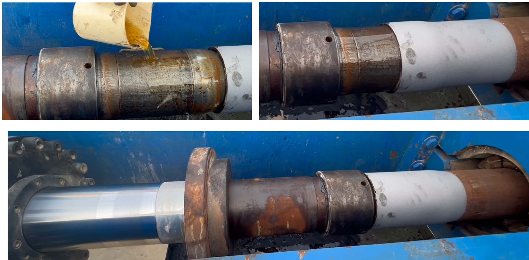
Рисунок 8 – Формирование раструбного конца трубы
